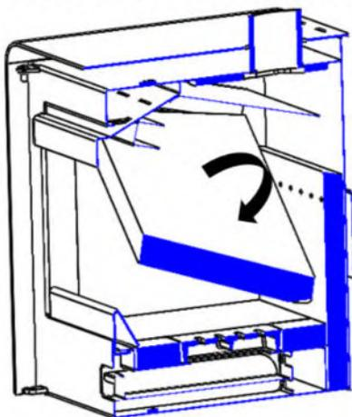
Figure n°9 - Extraction des déflecteurs en vermiculite
